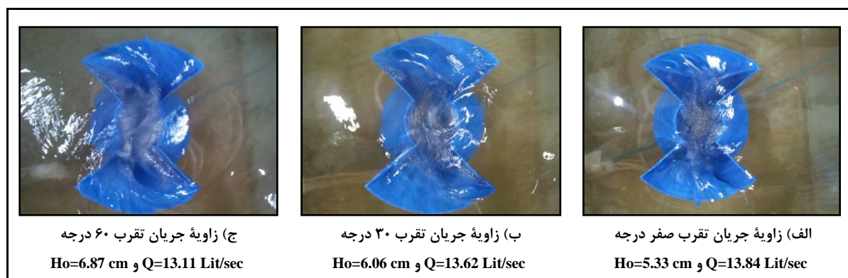
شکل ۷- اثر زاویه جریان تقرب بر میزان بار آبی در سرریزهای با ارتفاع نسبی P/D معادل ۱/۵
