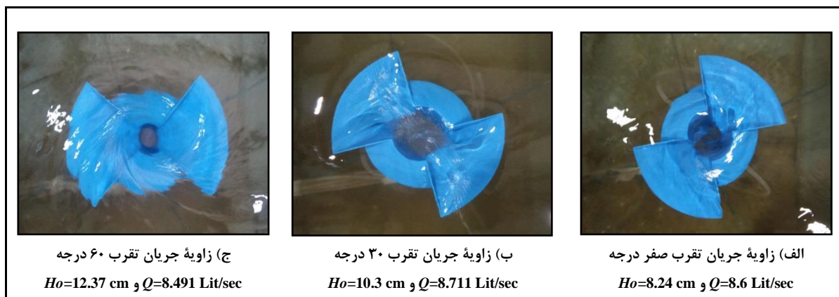
شکل ۵- اثر زاویه جریان تقرب بر میزان بار آبی در سرریزهای با ارتفاع نسبی P/D معادل ۰/۵
