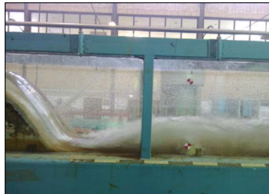
شکل ۳- پرش هیدرولیکی تثبیت شده توسط آستانه با بازشدگی ۲۵ درصد در فاصله نسبی \frac{L_s}{y_1} = 10/4 ( L_s = 50 \text{ cm} )
