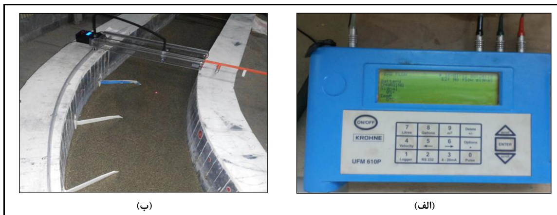
شکل ۳- الف) دی‌سنج اولتراسونیک و ب) دستگاه برداشت پروفیل رسوب ساخت شرکت آذر آشنا آب تبریز
