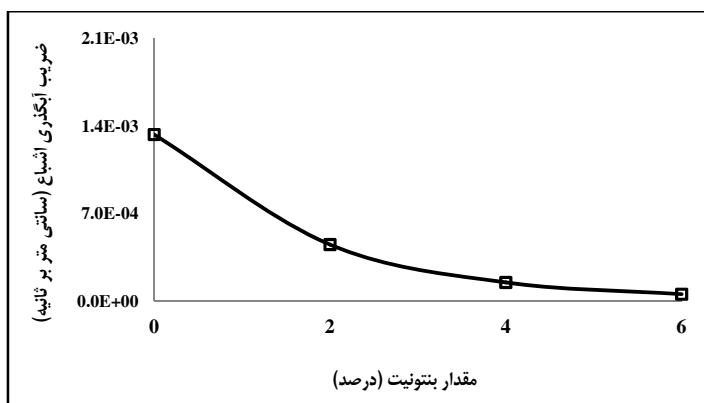
شکل ۱۳- تأثیر مقدار بنتونیت بر ضریب آبگذری اشباع افقی نمونه ۱
