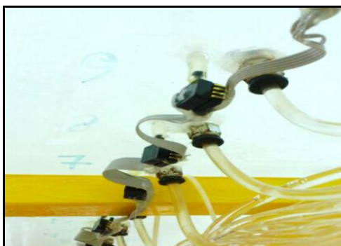
شکل ۵- نحوه اتصال ترانسدیوسر فشار در کف فلوم
