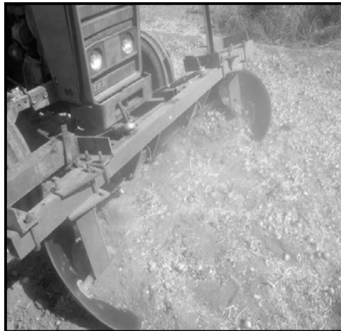
شکل ۶- زاویه واقعی قرارگیری بشقاب‌ها برای برقراری عمق مطلوب به هنگام کار با کنارزن بشقابی
