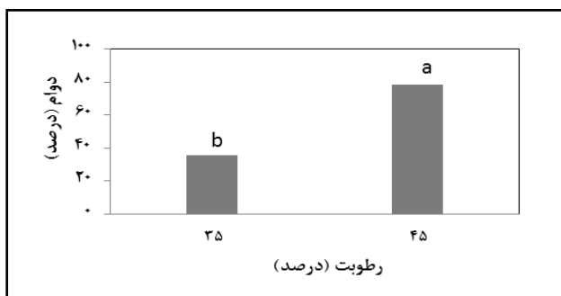
شکل ۶- اثر مقدار رطوبت خمیر کمپوست بر میانگین دوام پلت‌های تولید شده در سرعت‌های مختلف چرخش پیچ.
