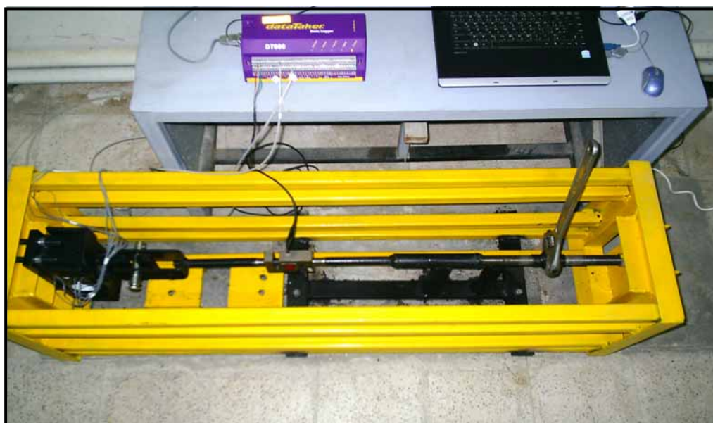
شکل ۴- دستگاه واسنجی مبدل رینگ‌ی نیرو با ساختار هشت وجهی
