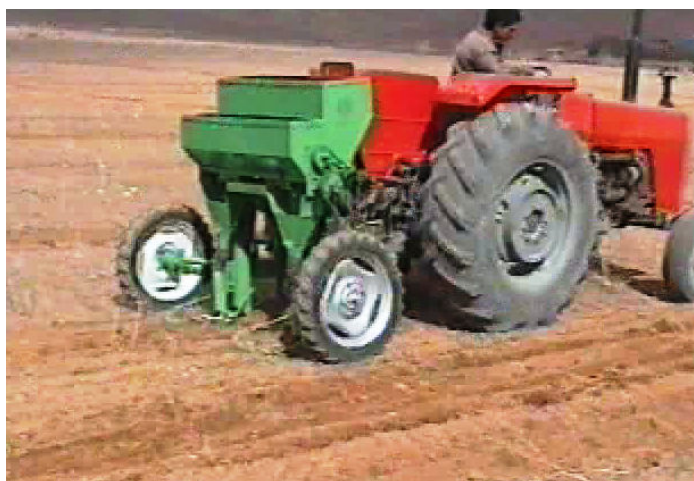
شکل ۲- نمای دستگاه مالچ - بذرکار هنگام انجام عملیات با اتصال به تراکتور
