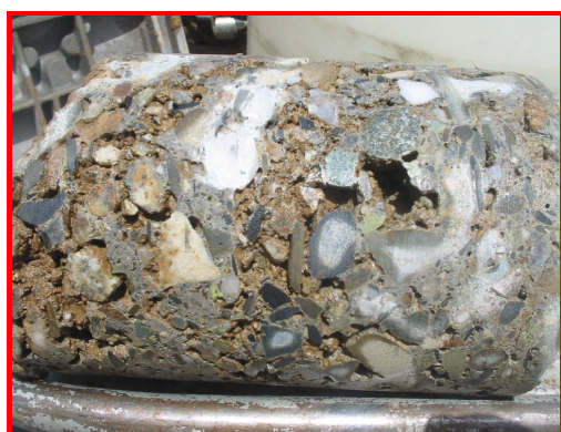
شکل ۱- وضعیت ترکیب مصالح و تراکم بتن در منطقه
