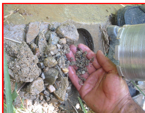
شکل ۱- وضعیت ترکیب مصالح و تراکم بتن در منطقه
