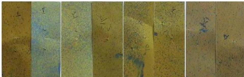
شکل شماره ۵- کارت‌های حساس در مسیر سمپاشی الف- بوم دار تراکتوری ب- صفحات چرخان
