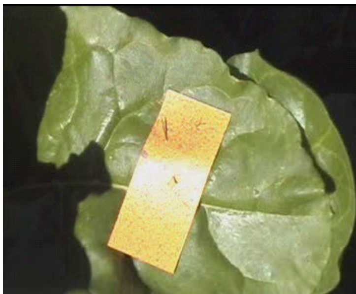
شکل شماره ۳- موقعیت کارت حساس روی برگ‌ها در مسیر سمپاشی
