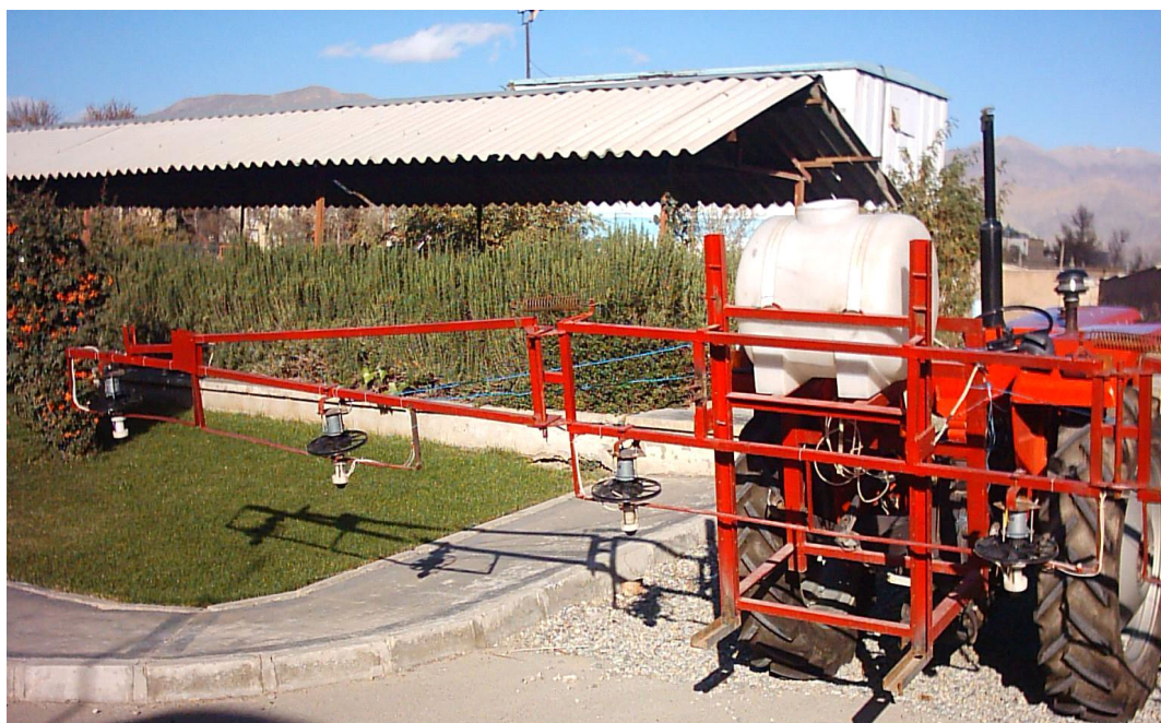
شکل شماره ۲- سمپاش بوم دار تراکتوری مجهز به صفحات چرخان
