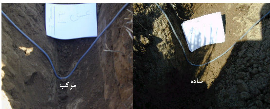
شکل شماره ۶- پروفیل واقعی گسیختگی خاک در مزرعه پس از کاربرد گاوآهن ساده و مرکب
