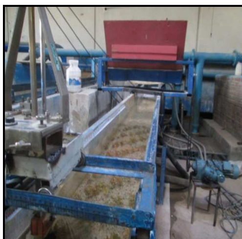
شکل ۲- جانمایی دستگاه تزریق رسوب در بالادست فلوم
