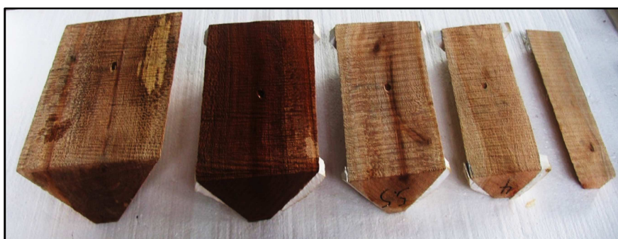
شکل ۳ - نمایی از برخی آستانه‌های انتهایی لبه‌پهن با ارتفاع‌های مختلف به کار رفته در آزمایش‌ها
