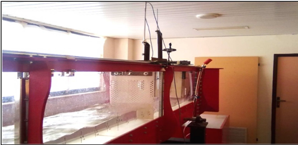
شکل ۶- نمونه‌ای از جاگذاری صفحه مشبک در مسیر جریان بعد از دریچه
