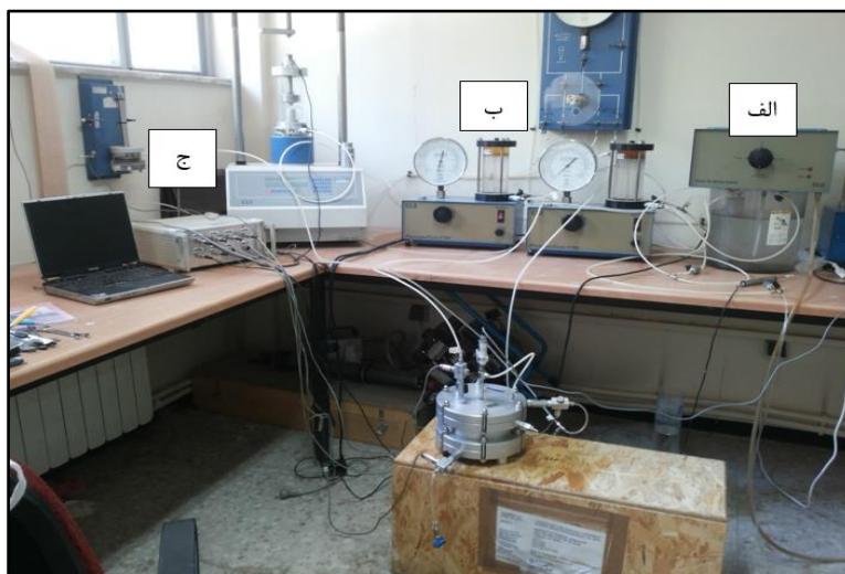
شکل ۲- نمایی از دستگاه تحکیم هیدرولیکی به همراه تجهیزات لازم: الف) سیستم هواگیری آب، ب) دستگاه مولد فشار و ج) دیتالاگر
