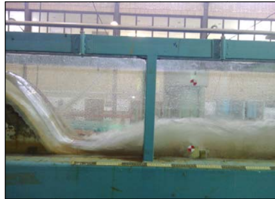
شکل ۳- پرش هیدرولیکی تثبیت شده توسط آستانه با بازشدگی ۲۵ درصد در فاصله نسبی \frac{L_s}{y_1} = 10/4 ( L_s = 50 \text{ cm} )
