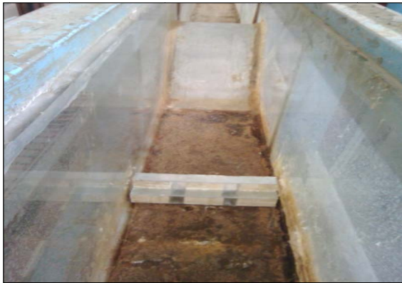
شکل ۴- نمایی از آستانه پلکانی با ۲۵ درصد بازشدگی و نحوه قرارگیری آن در حوضچه آرامش
