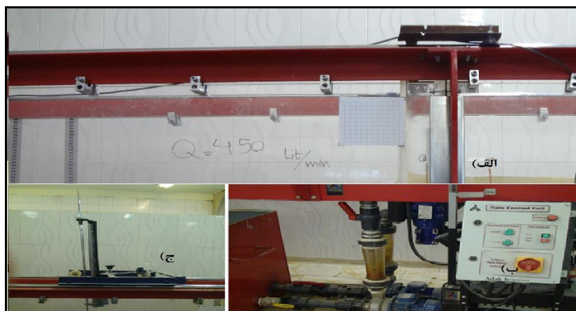
شکل ۲- روتامترهای تنظیم کننده دبی پمپ جریان و ترازسنج میله‌ای
