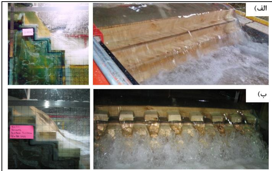
شکل ۷- الف) تصویر رو به رو و نیمرخ سرریز S_1H_1L_1b_1 در h/y_c=1.5 و ب) تصویر رو به رو و نیمرخ سرریز S_1H_1L_1b_1 در h/y_c=1.5
