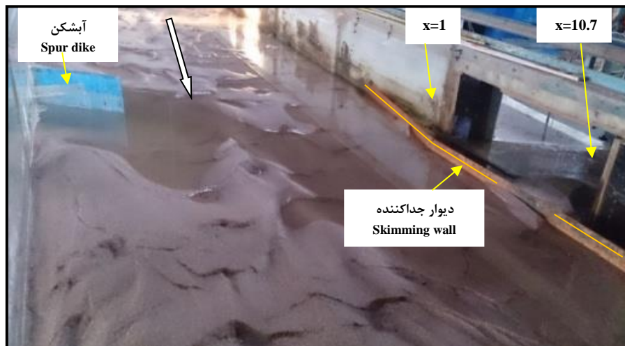
شکل ۲- دیوار جداکننده و رسوبات انباشته شده جلو دهانه آبگیر
