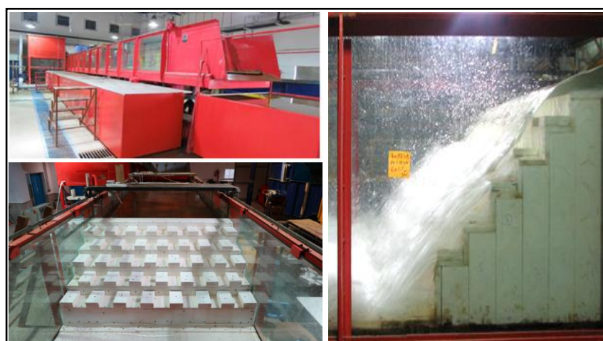
شکل ۳- تصویرهایی از فلوم آزمایشگاهی و سرریزهای پلکانی مورد مطالعه
