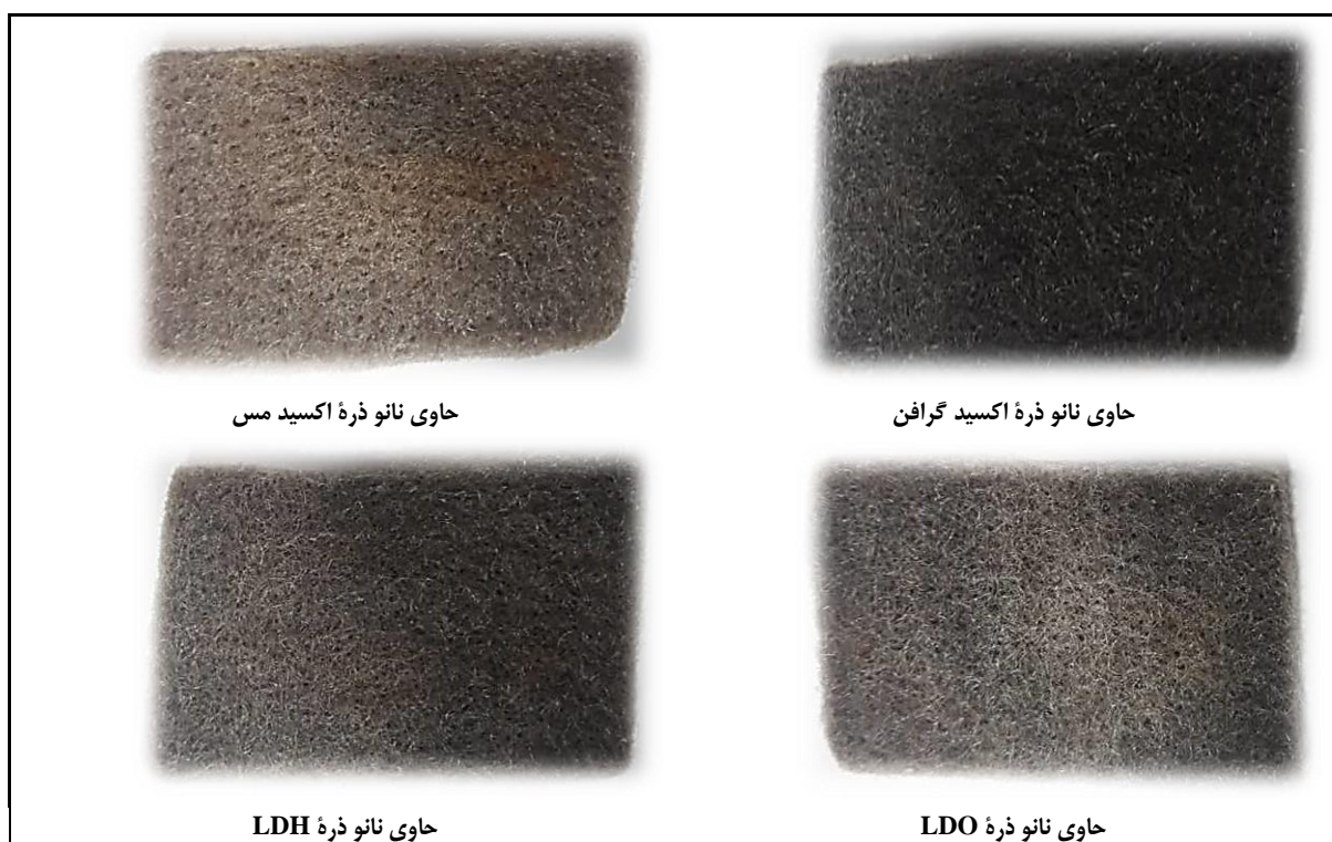
شکل ۱۰- پلیمریزاسیون شیمیایی الیاف ژئوتکستایل بر اثر افزودن چهار نوع نانو ذره به پلیمر آنیلین
