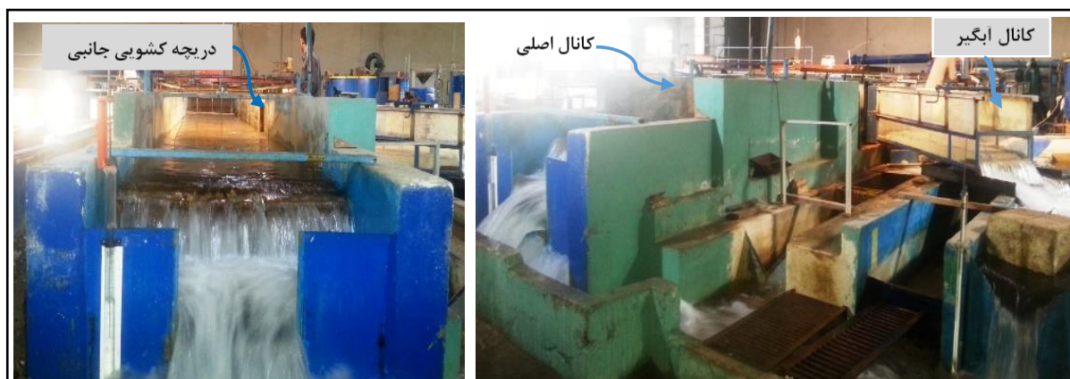
شکل ۴- فلوم آزمایشگاهی و دریچه جانبی مورد استفاده در این تحقیق Fig. 4- Experimental flume and the side sluice gate used in the experiments
