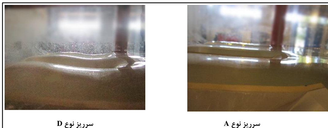
شکل ۸- سطح جریان هنگام عبور از تاج سرریزهای نوع A و D
