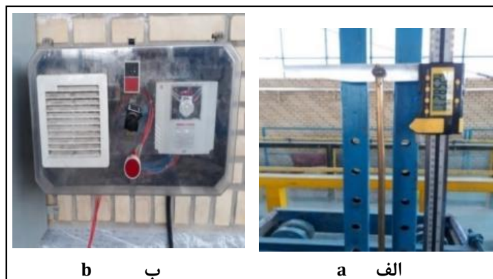
شکل ۴ - الف) عمق‌سنج دیجیتال، ب) دستگاه دیجیتالی تغییر دهنده فرکانس پمپ Fig. 4- a) Digital depth gauge, b) Digital device to change the pump frequency
