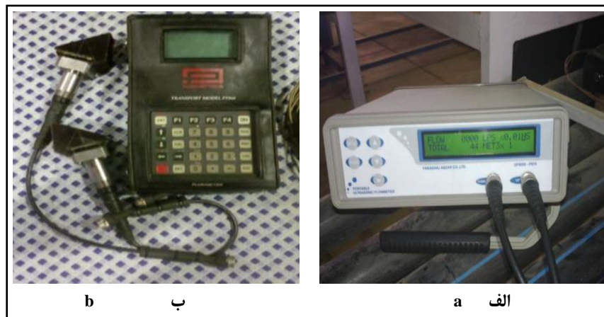
شکل ۳- الف) دبی سنج آلتراسونیک مدل UF6000 و ب) دبی سنج مرجع برای کالیبراسیون Fig. 3- a) UF6000 Ultrasonic Flow Meter and b) Reference Flow Meter for Calibration
