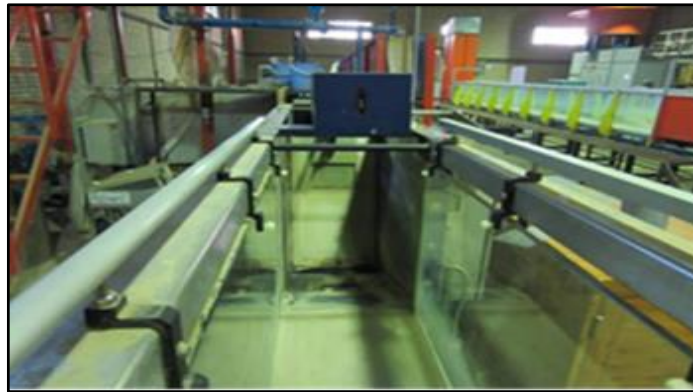
شکل ۲- دریچه انتهایی فلوم آزمایشگاهی برای تنظیم سطح آب پایین دست Fig. 2- The tailgate of flume for adjustment water level
