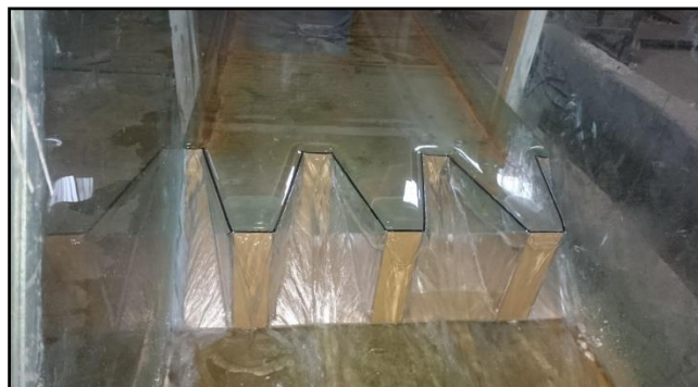
شکل ۳- جریان عبوری از روی سرریز کلید پیانویی دوزنقه ای ۱۲ درجه
