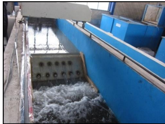
شکل ۱۱- تعبیه بلوک در انتهای حوضچه
