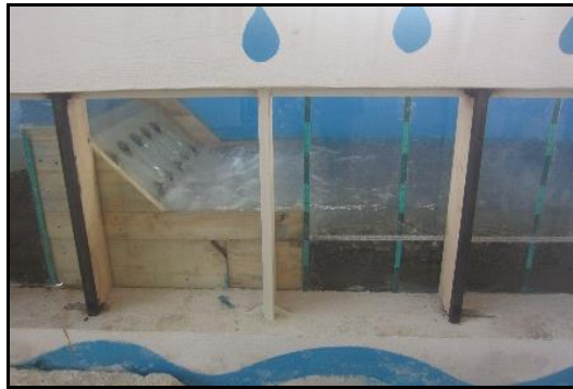
شکل ۹- استغراق در نتیجه افزایش ارتفاع پایاب
