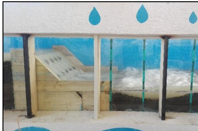
شکل ۶- آزمایش مبنا برای تعیین عمق آبشستگی تعادلی 6 - Base test to equilibrium scour depth determination
