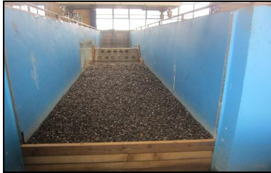
شکل ۸- افزایش ارتفاع کانال برای ایجاد پرش مستغرق
