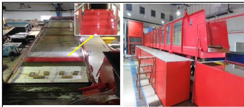
شکل ۳- تصویرهایی از فلوم آزمایشگاهی و سرریز پلکانی
