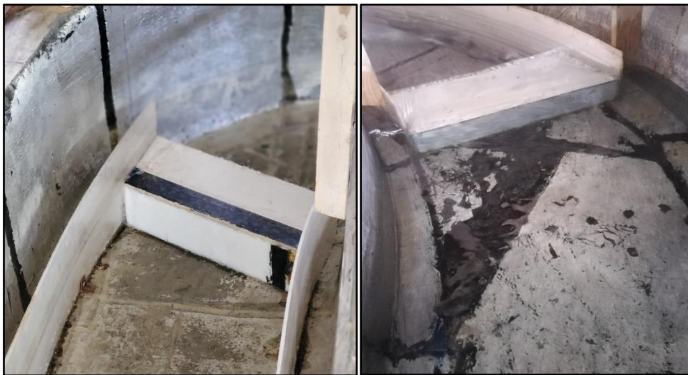
شکل ۲- جانمایی سرریز و آبگیرها در پیچ کانال
