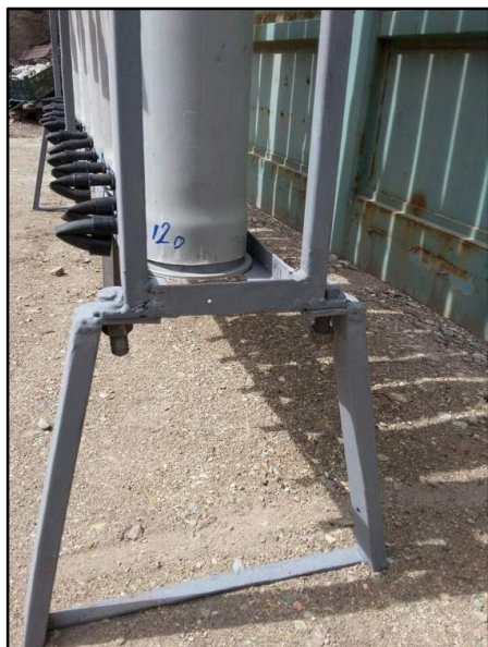
شکل ۲- چارچوب فلزی ساخته شده برای استقرار ستون‌ها Fig. 2- Metal frame made for establishment of columns
