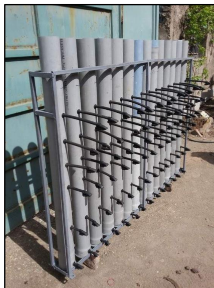
شکل ۱- ستون‌های آماده شده پس از نصب زهکش‌ها Fig. 1- Prepared columns after drains installation
