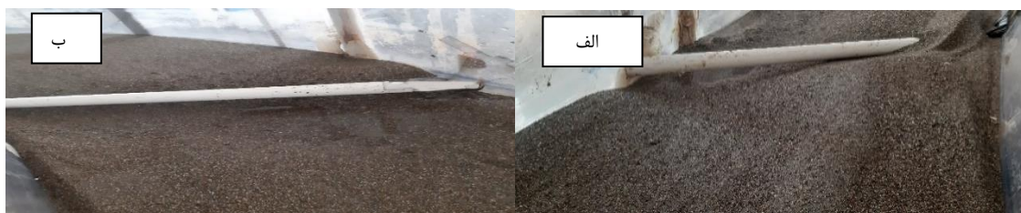
شکل ۱۹- حداکثر میزان آبشستگی موضعی زیر لوله: الف) دافع، ب) جاذب
