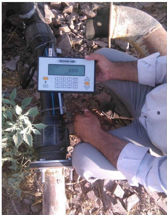
شکل ۱- دستگاه دبی‌سنج اولتراسونیک مورد استفاده برای سنجش دبی آب در سامانه‌های آبیاری تحت فشار (ضیاء آباد - استان قزوین) Figure 1- Ultrasonic flow meter used to measure water flow in pressurized irrigation systems (Zia Abad - Qazvin province)
