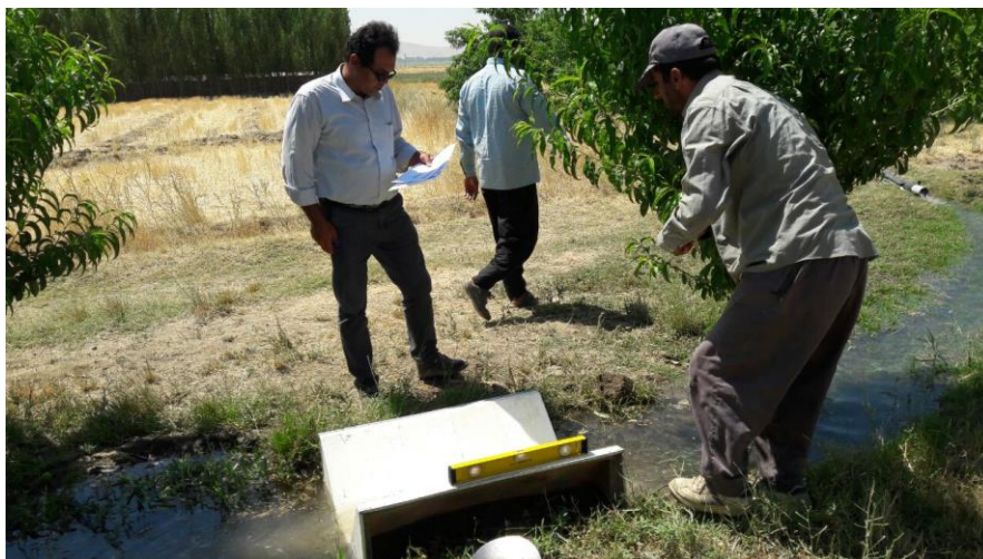
شکل ۲- اندازه‌گیری آب کاربردی در یک باغ گردو ( تویسرکان) با استفاده از فلوم WSC Figure 2 - Measurement of applied water in a walnut garden (Tuiserkan) using WSC flume
