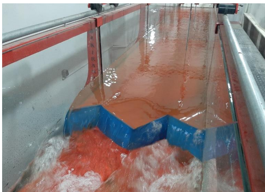
شکل ۲- سرریز کنگره‌ای دو سیکل مثلثی با راس رو به بالا
