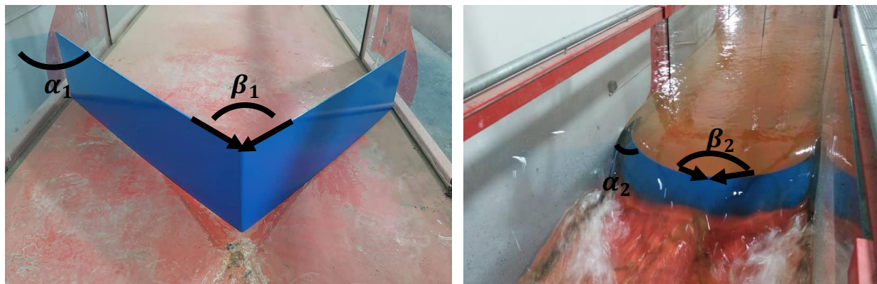
شکل ۴- الگوی جریان در سرریزهای کنگره‌ای تک‌سیکل CL1 و TL1 Figure 4. Flow pattern in CL1 and TL1 one-cycle labyrinth weirs
