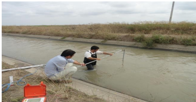
شکل ۶- اندازه گیری دبی برای تعیین میزان نشت
