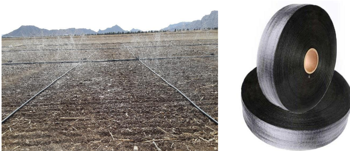
شکل ۱- نوارهای آبیاری تاشو (سمت راست) و سامانه آبیاری بارانی تاشو در حال کار (سمت چپ) Figure 1- Rain flat irrigation strips (right) and rain flat sprinkler irrigation system in operation (left)
