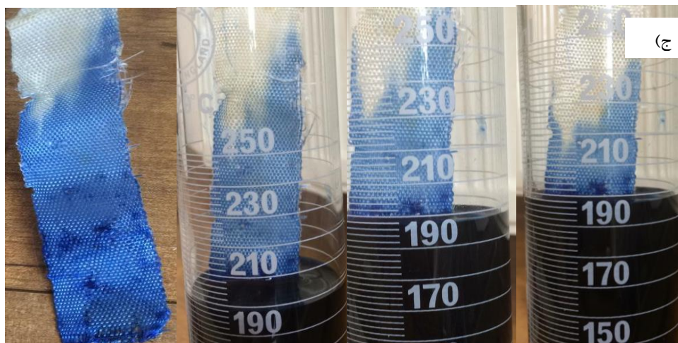
شکل ۳- میزان صعود محلول رنگی در الیاف P200 (الف)، P186 (ب) و ELE (ج)
