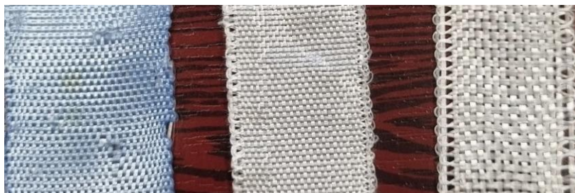
شکل ۲- شمایی از تراکم الیاف شیشه‌ای حصیری مورد استفاده در پژوهش (به ترتیب از سمت راست P200، P186 و ELE) Fig. 2 - Schematic of the density of glass mat fibers used in the research (from the right P200, P186 and ELE respectively)
