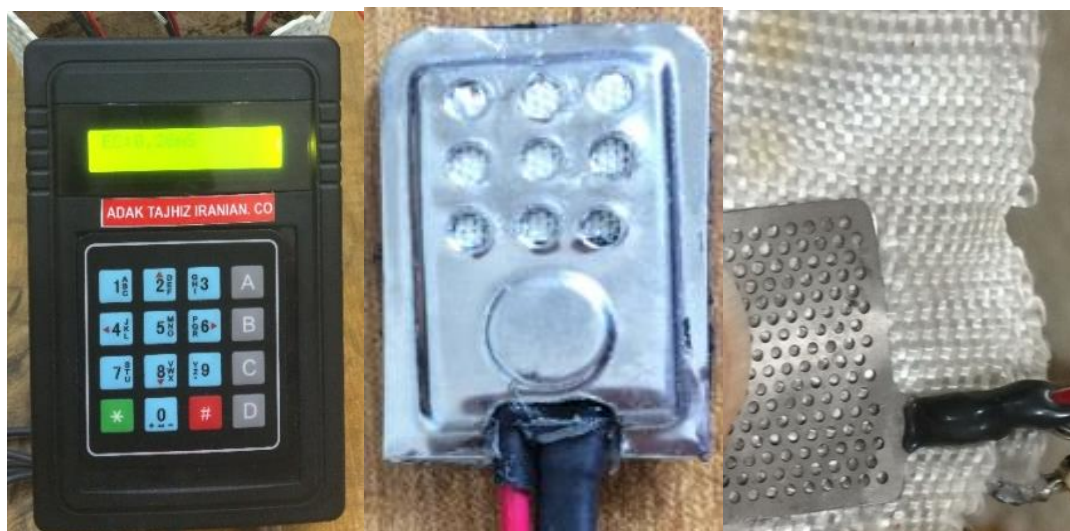
شکل ۱- شمایی از الیاف و الکتروود (سمت راست)، بلوک متخلخل (وسط) و رسانایی‌سنج طراحی شده (سمت چپ) Fig.1- Schematic of the fibers and electrode (right), the porous block (middle), and the designed conductivity meter (left)
