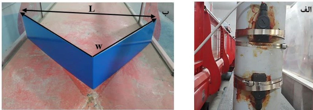
شکل ۲- الف) دبی سنج اولتراسونیک و ب) مدل آزمایشگاهی سرریز کنگره‌ای مثلثی Fig. 2- Laboratory models of triangular labyrinth weir
