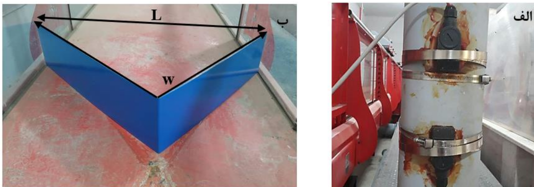
شکل ۲- الف) دبی سنج اولتراسونیک و ب) مدل آزمایشگاهی سرریز کنگره‌ای مثلثی
