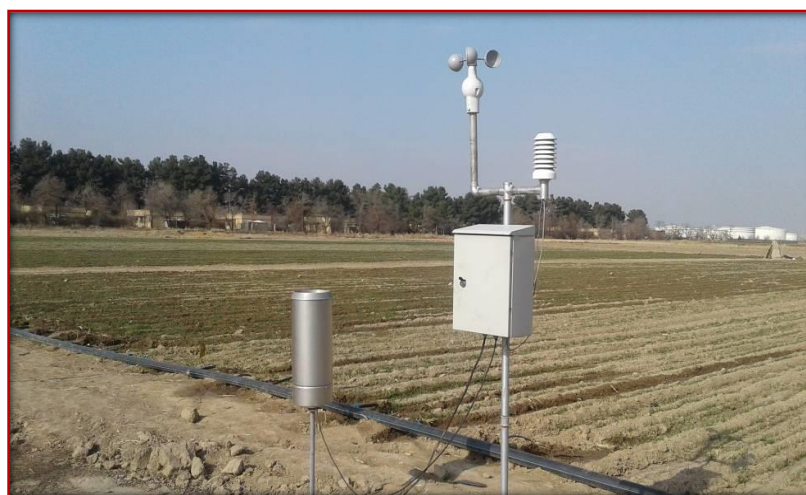
شکل ۱- ایستگاه هواشناسی برای جمع‌آوری داده‌های بهنگام هواشناسی
