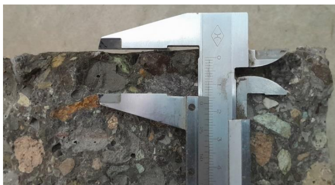
ب) سنجش عمق نفوذ آب پس از شکست نمونه (b) Measurement of water penetration depth after specimen failure
