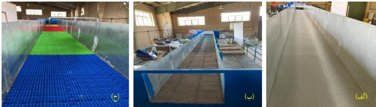
شکل ۳- پوشش‌های به کار رفته در پژوهش، الف-گالوانیزه، ب-پوشش مشبک پایه کوتاه، ج- پوشش مشبک متراکم Fig. 3- Tested Bed roughness: (a) Galvanized iron; (b) Short height mesh; and (c) High-dense mesh
