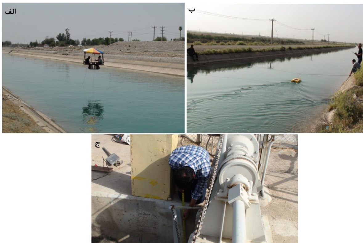
شکل ۵- (الف) اندازه‌گیری دبی جریان خروجی از دریچه با استفاده از مولینه و پل کابلی، (ب) اندازه‌گیری دبی جریان خروجی دریچه با استفاده از قایق کیولاینر و (ج) کنترل عملکرد کنتور اندازه‌گیری گشودگی
