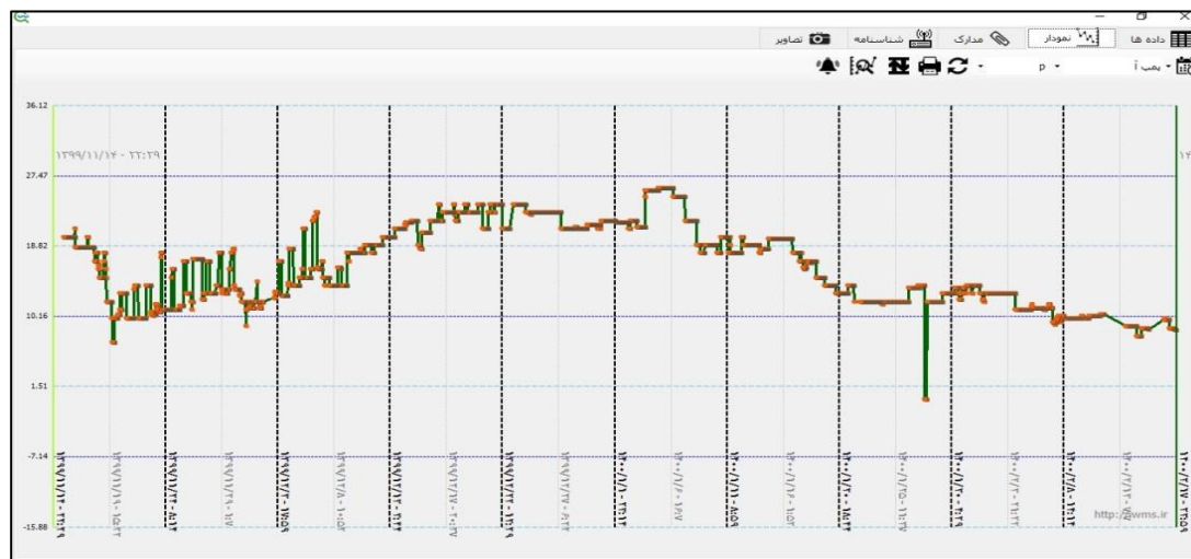
شکل ۱۴- نمونه تغییرات درصد گشودگی دریچه قطاعی چپ ورودی کانال W1 دز با زمان در سامانه Water Query (ساعت ۲۲:۲۹ روز ۱۳۹۹/۱۱/۱۴ تا ساعت ۲۲:۵۹ روز ۱۴۰۰/۰۲/۱۷)
