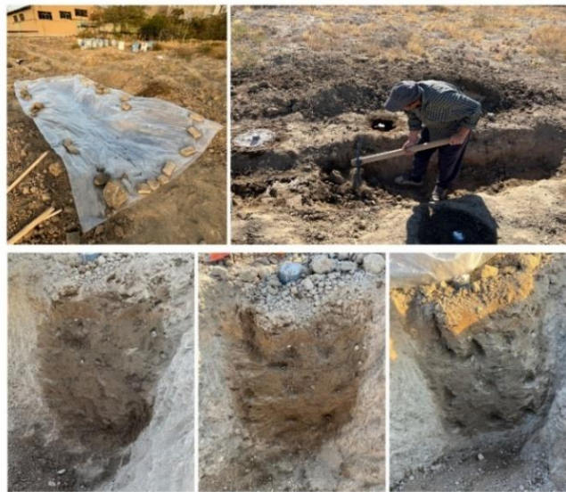
شکل ۴- برداشت ترانشه‌ای و بازسازی هندسی پیاز رطوبتی در سه بازه زمانی پس از آبیاری
