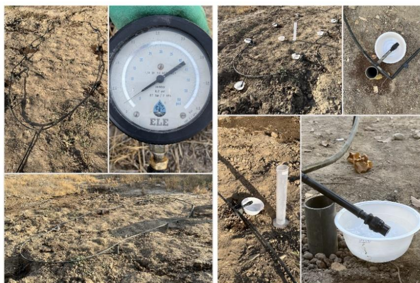
شکل ۳- نمای بابلر-استوانه PVC شامل آرایش حلقه‌ای لوله، کنترل فشار و دبی، و اجرای آبیاری حین کار Fig. 3- Bubbler-PVC cylinder system during irrigation, showing the ring-shaped pipe arrangement and pressure and discharge control
