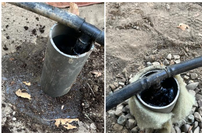
شکل ۵- انسداد منافذ استوانه و سرریز آب در بسترهای ورمی‌کمپوست و ژئوتکستایل
