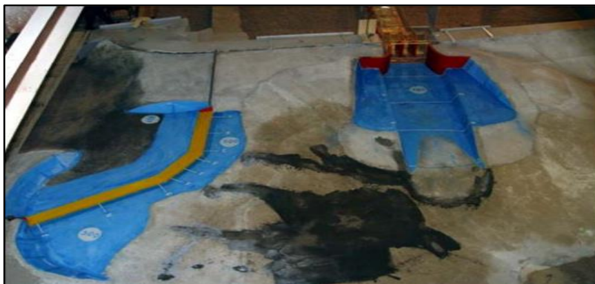
شکل ۱- ساخت و اجرای مدل آزمایشگاهی سرریز
