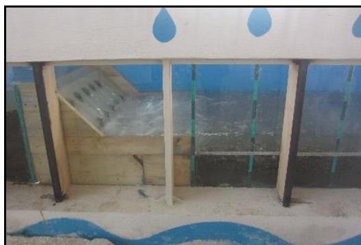
شکل ۹- استغراق در نتیجه افزایش ارتفاع پایاب
