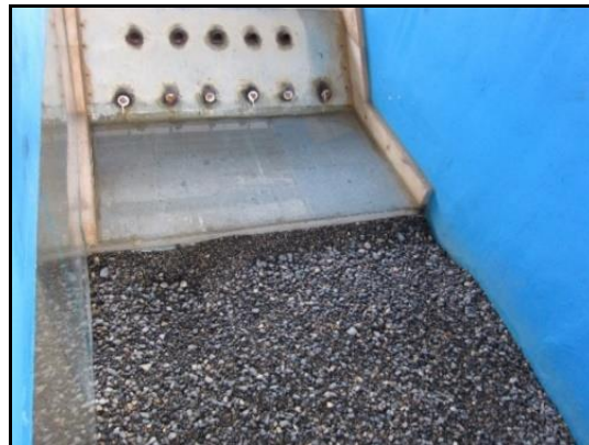
شکل ۱۰- پرش مستغرق با قرار دادن بلوک در انتهای حوضچه آرامش
