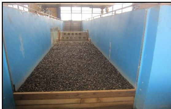
شکل ۸- افزایش ارتفاع کانال برای ایجاد پرش مستغرق
