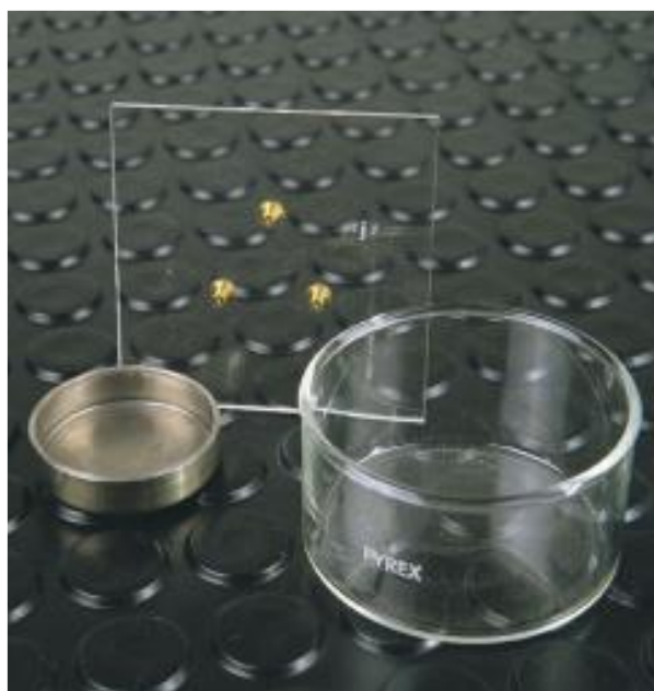
شکل ۳- ظرف‌های مورد استفاده در تعیین حد انقباض به روش حجمی Fig. 3- Containers used to determine the shrinkage limit by volume method
