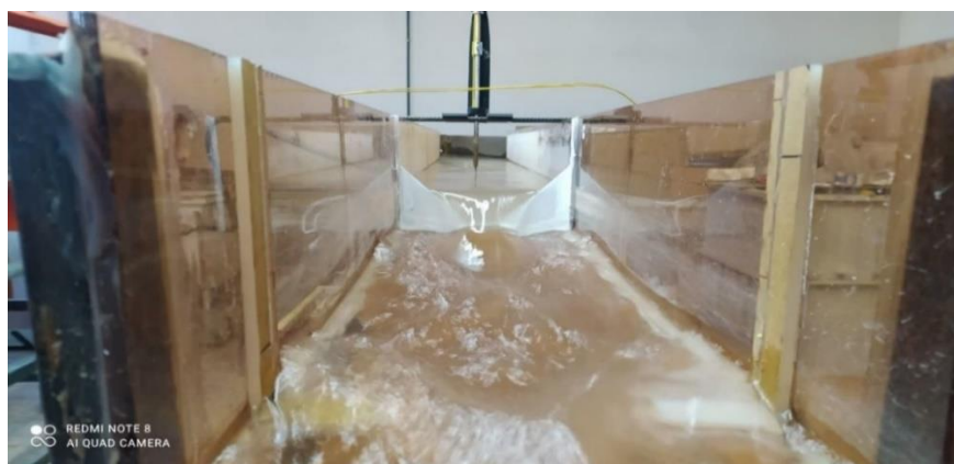
شکل ۲- کانال آزمایشگاهی با عرض کف ۲۵ سانتی‌متر حین آزمایش Fig. 2- flume with a floor width of 25 cm during testing
