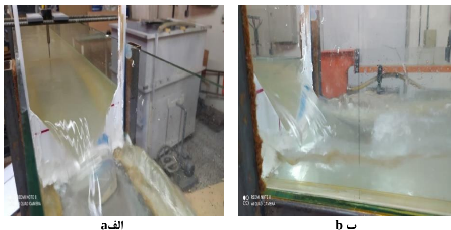
شکل ۱- کانال آزمایشگاهی با عرض کف ۲۰ سانتی‌متر حین آزمایش. الف، جریان آزاد ب، جریان مستغرق Fig. 1- flume with a floor width of 20 cm during testing. a; Free flow b; submerged flow
