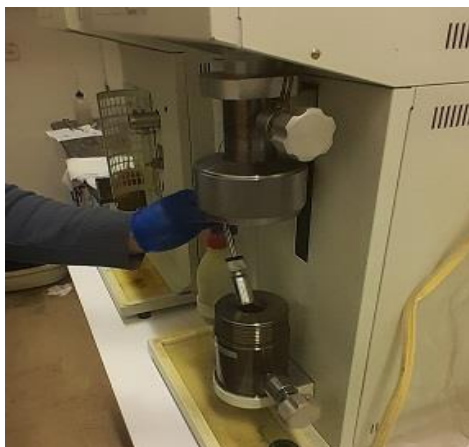
شکل ۲- دستگاه مورد استفاده برای آزمون تخلخل‌سنجی جیوه
