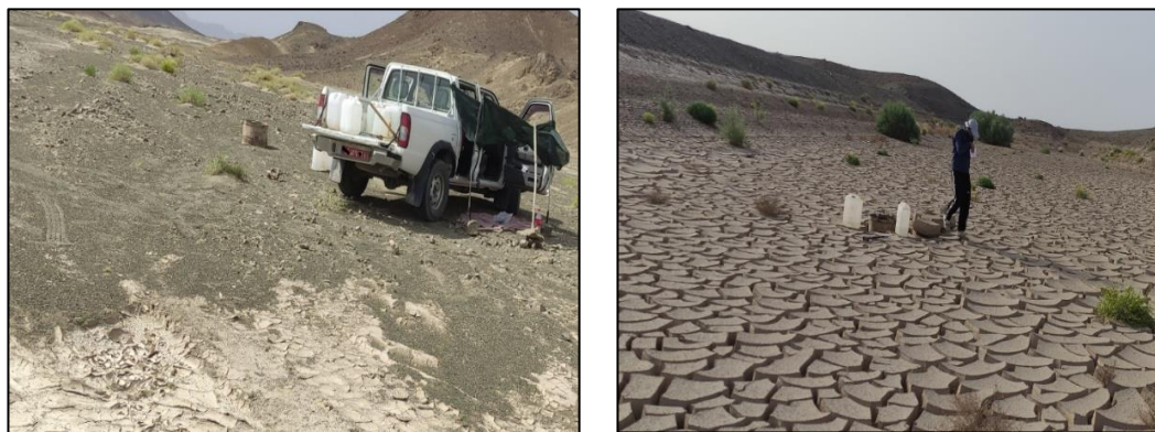
الف- اندازه‌گیری میزان نفوذپذیری مخزن بند در منطقه شاهد A-Measuring the permeability of the dam reservoir in the test area ب- اندازه‌گیری میزان نفوذپذیری مخزن بند در پای بند B-Measuring the permeability of the dam reservoir at the next of the dam
