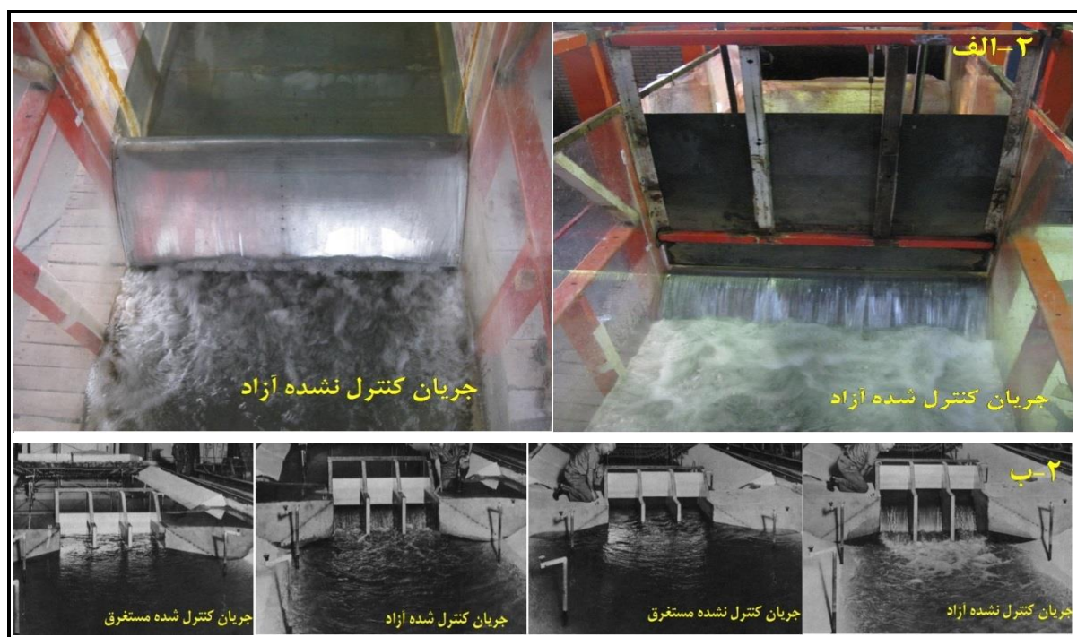
شکل ۲- حالت‌های مختلف جریان. الف) مدل آزمایشگاهی تحقیق حاضر و ب) مدل سرریز دریچه‌دار آرکانزاس
